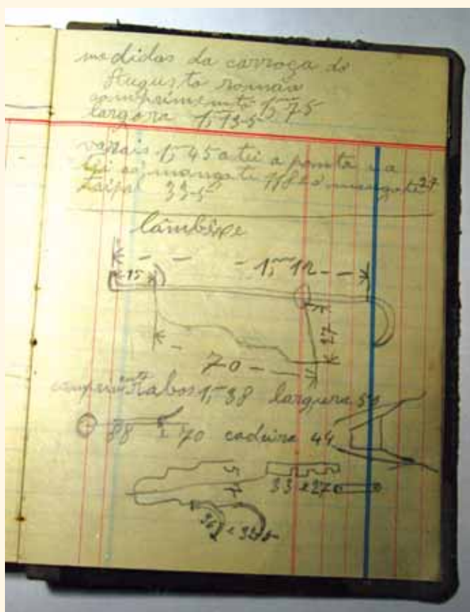
Apontamentos referentes a medidas de carroça e desenho, com dimensões de um instrumento agrícola encomendado: “lambexa”
